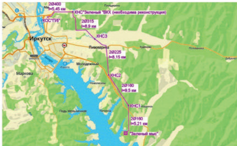
б Рис. 6.13. Проект 1 прокладки сетей водоотведения: а – вариант 1 (схема МУП «Водоканал»); б – вариант 2 (схема «Гранд Байкал»)
